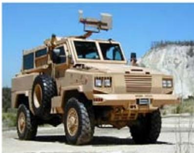
**Especificaciones.** Protección contra explosiones de minas / UXO / IED, protección balística, alta movilidad protegida, configuraciones 4x4, torreta montable con arma.
